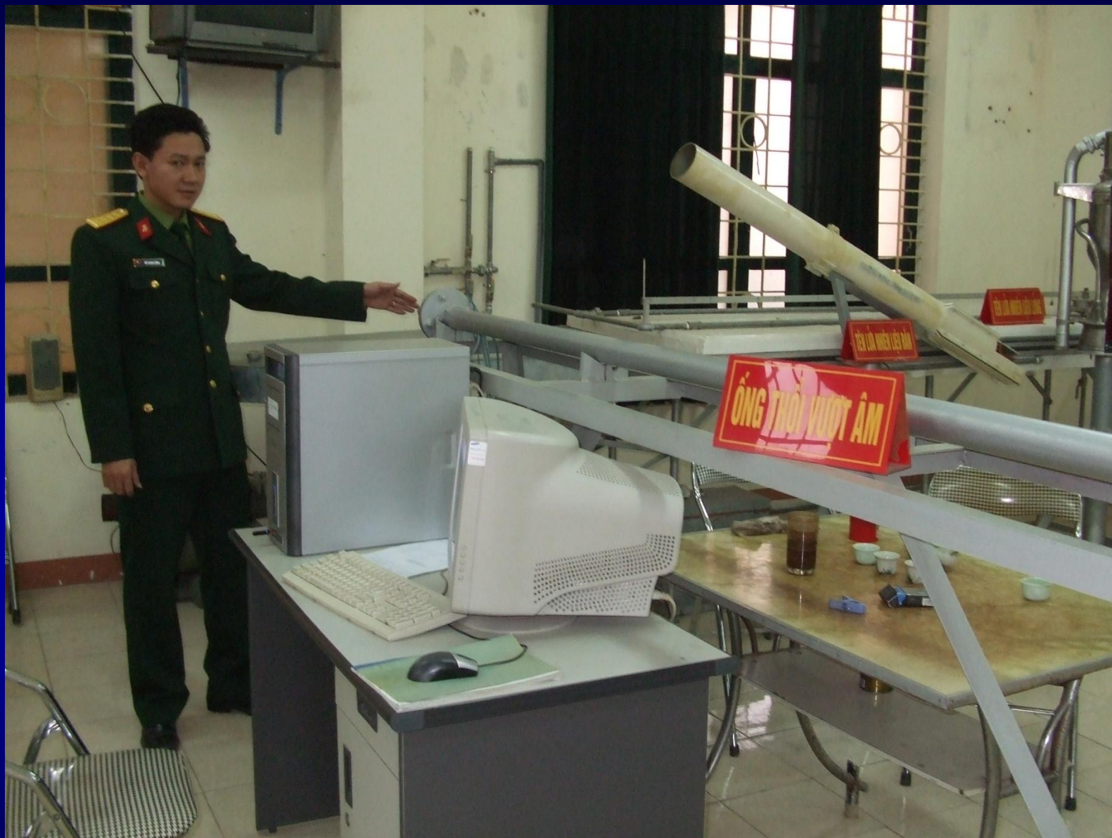
Thiết bị "Ống thổi vượt âm" trong phòng thí nghiệm Nhiệt kỹ thuật
